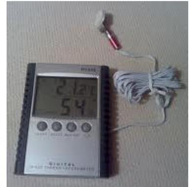
Fig.15 Termo higrómetro digital
